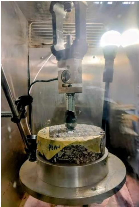
Figur 59. Foto av apparaten för intryckningstest.
