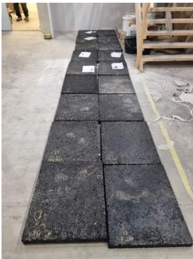
Figur 15. Packade asfaltsplattor. Foto: Patryk Witkiewicz.
