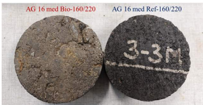
Figur 52. Provkroppar (AG 16-asfaltmassor med 160/220 bindemedel) efter MIST-konditionering.
