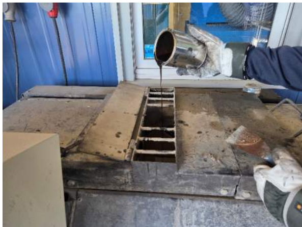
Figur 12. Tillsättning av bindemedel vid blandning av asfaltmassa. Foto: Patryk Witkiewicz.
