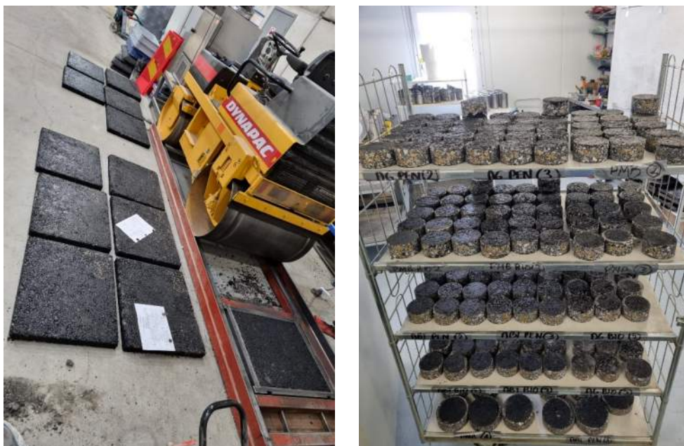
Figur 13. Tillverkning av provkroppar. Till vänster: packning av asfaltsplattor på Skanskas labb i Västerhaninge; till höger: borrkärnor från plattorna. Foton: Patryk Witkiewicz.
