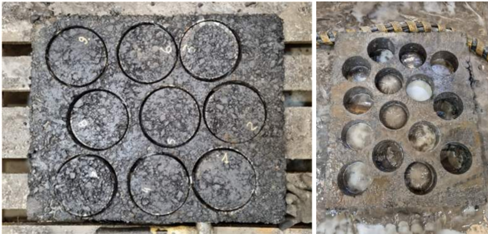
Figur 16. Borrning av kärnor med diametrar på 150 mm (till vänster) och 100 mm (till höger). Foton: Patryk Witkiewicz.
