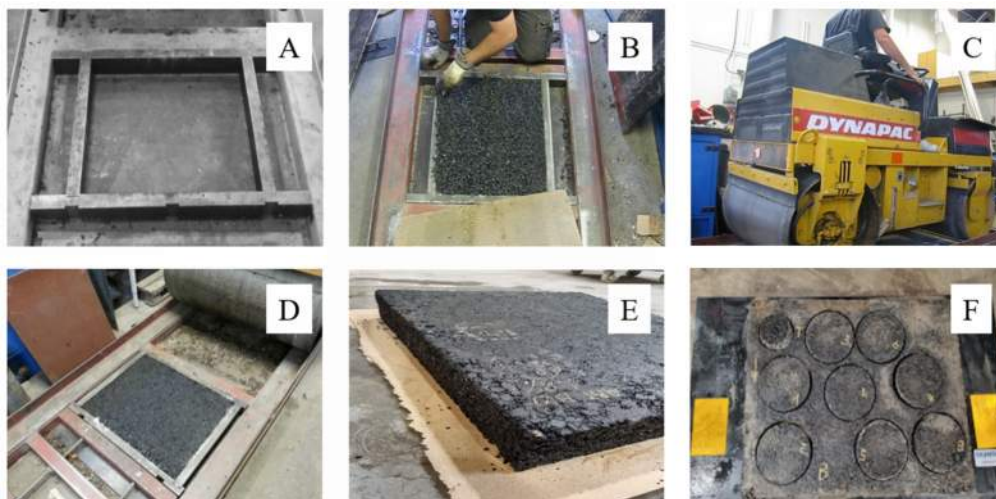
Figur 14. Olika steg för att tillverka provkroppar. (A) Stålformen, (B) Gjutning av asfaltmassa i formen, (C) Vältning av platta, (D) Platta efter packning, (E) Färdig platta, (F) Framtagning av borrhärnor. Foton: Patryk Witkiewicz.
